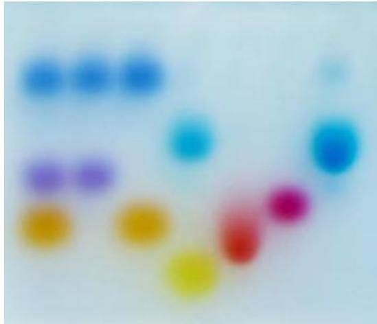
1. Las moléculas cargadas viajarán a través de la electroforesis según su carga y tamaño. Mientras que la forma es importante en el caso de biomoléculas (ADN y proteínas), en el caso de los colorantes no es un factor a tener en cuenta.
