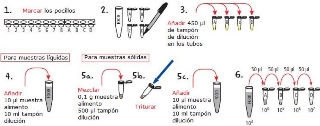
1. Utilizando un marcador de punta fina, DIBUJAR una caja alrededor de las columnas 1-8 y otra alrededor de las columnas 9-12 de la tira de microtitulación. MARCAR los primeros ocho pocillos de la tira de microtitulación con los números 1-8 y los últimos cuatro pocillos con las letras A, B, C, D.
